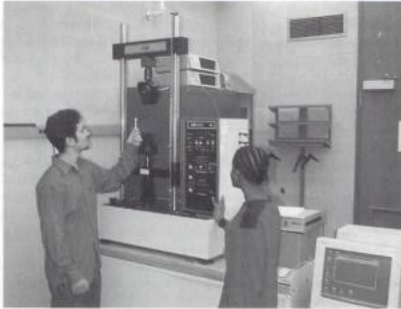
Figura 6-8 Alumnos efectuando un ensayo de tensión, con una máquina automatizada de pruebas. (Cortesía de Pradeep Phulé.)
