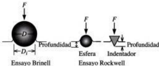
Figura 6-23 Penetradores para los ensayos de dureza Brinell y Rockwell.
