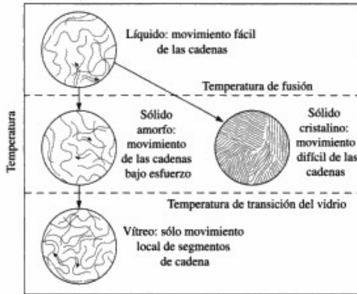
Figura 15-12 Efecto de la temperatura en la estructura y en el comportamiento de los materiales termoplásticos.
