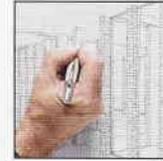
Para realizar la textura fugada de los bloques de hormigón que forman las columnas de la escena, se recomienda trazar, con ayuda de un papel a modo de regla, las juntas ubicadas cada 5 o 10 bloques, de manera que sirvan de guía para dibujar las restantes.
