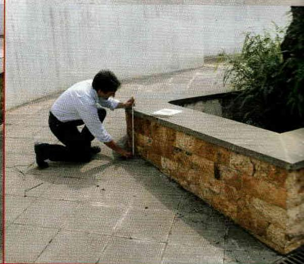
Definimos una retícula ortogonal de referencia y medimos los distintos puntos del paramento ondulado en relación con la misma línea horizontal.
