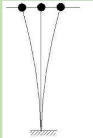
Si se trata de una barra de varias masas, se deforma según la siguiente figura:
