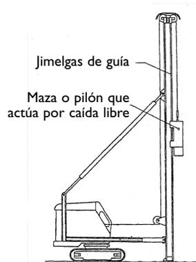
Pala metálica equipada para hincar pilotes.
