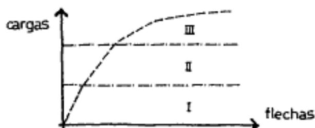
Estado I: Sin fisuras. El comportamiento del material es totalmente elástico. La tensión de tracción en el hormigón es menor a la de rotura.
