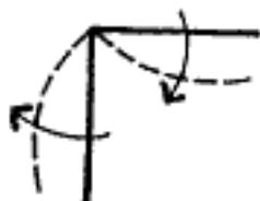
Rotaciones en igual sentido. Losa de tapa simplemente apoyada.
