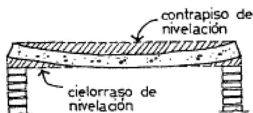
En algunas ocasiones, cuando las deformaciones son muy acentuadas, es necesario disimularlas en la parte inferior de la losa y para ello se recurre a cielorrasos aplicados de mucho espesor que aumentan notablemente la carga sobre la losa.
